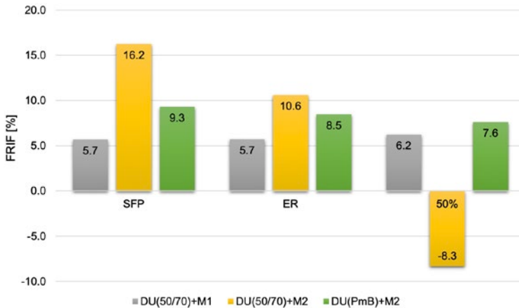
Slika 4. Uticaj prisustva geomreža na vek trajanja asfaltnih uzoraka
