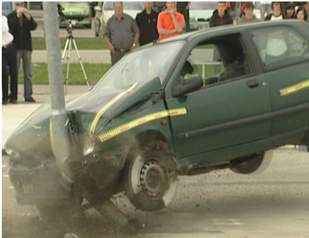
Slika 2: Zaustavljanje vozila sa brzinom naleta 46 km/h, trajanje udara 0,5 sekunde, usporenje -138 \text{ m/s}^2 Izvor: Probni udar u kruti stup – poligon Španik, Muska Sobota 2009 4
