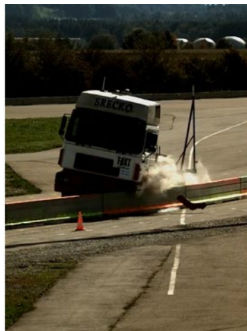
Udarno vozilo TB 42 (kamion od 10 tona pri 70 km/h i kut udarca od 15°) u "pametnu barijeru radne zone"
