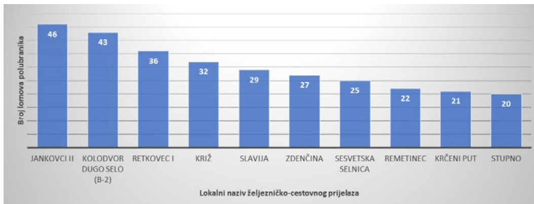
Slika 10. Učestali lomovi polubranika na istom željezničko-cestovnom u razdoblju od 2021. do 2024. godine [3, 5]
