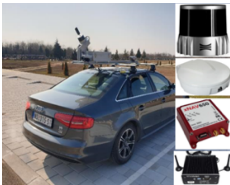
Slika 4 - Vozilo i oprema za snimanje oblaka tačaka
