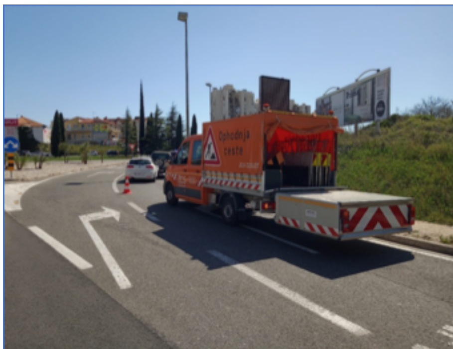
Slika 8.. Ophodarsko vozilo s ublaživačem udara u radnom položaju kod osiguranje prometne nesreće (izvor:ŽCS)
