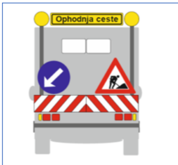
Slika 1. Propisani izgled ophodarskog vozila (izvor: Pravilnik o ophodnji javnih cesta)
