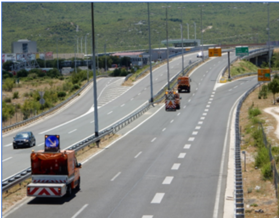
Slika 9.. Ophodarsko vozilo s ublaživačem udara u radnom položaju kod radova u pokretu (izvor:ŽCS)
