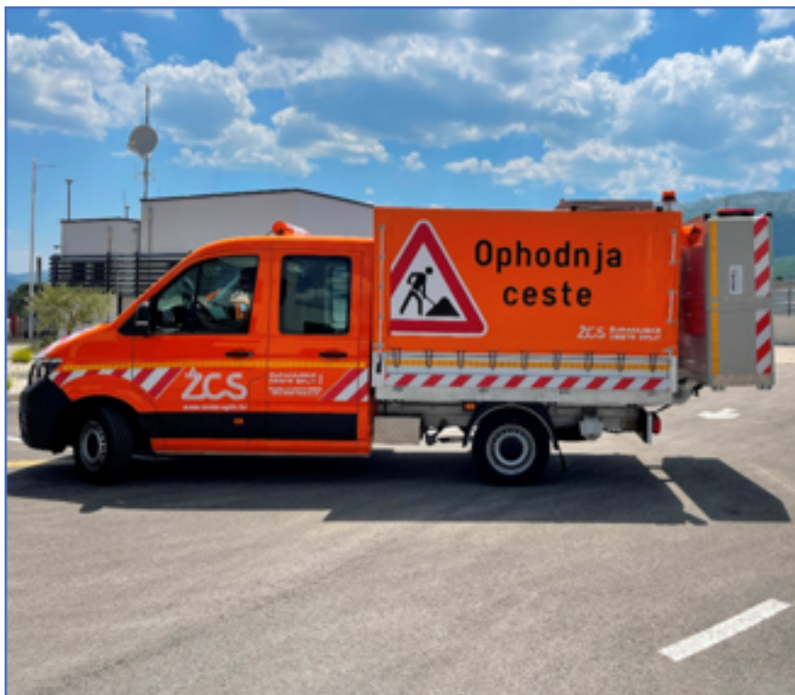
Slika 7.. Prvo ophodarsko vozilo VW Crafter s ugrađenim ublaživačem udara i LED mobilni panelom (izvor:ŽCS)
