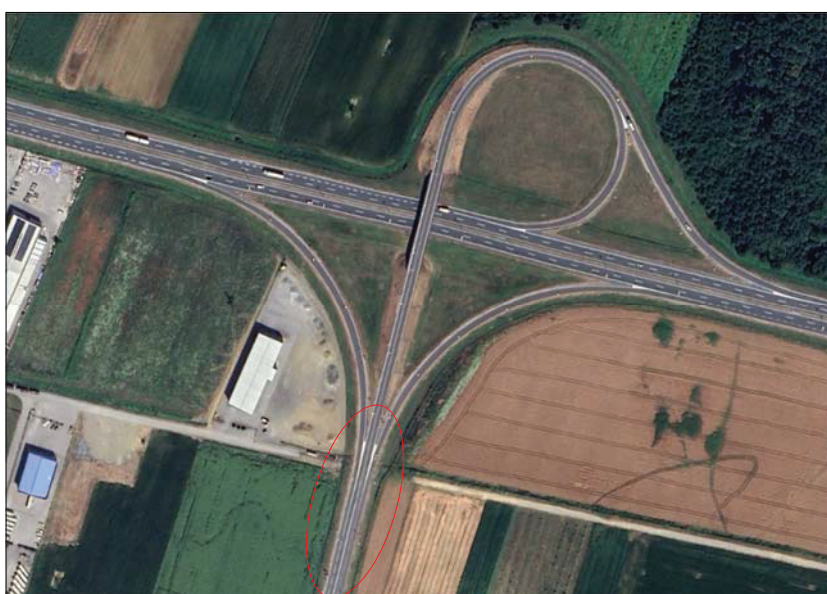
Slika 14. prijedlog izvesti strelice za obavezan smjer vožnje i po jednu strelicu ravno u trakama za suprotan smjer (Autoceste; ulazi na autoceste poslije naplatnih)
