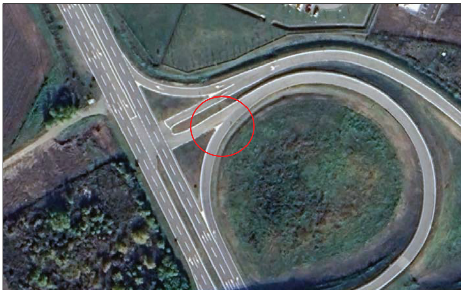
Slika 11. „T“ raskrižje s trakom za usporavanje, Prijedlog iscrtati isprekidanu zaustavnu crtu
