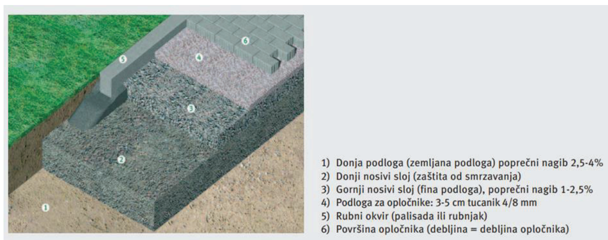
Slika 2. Presjek podloge za ugradnji i polaganje opločnika [2]
