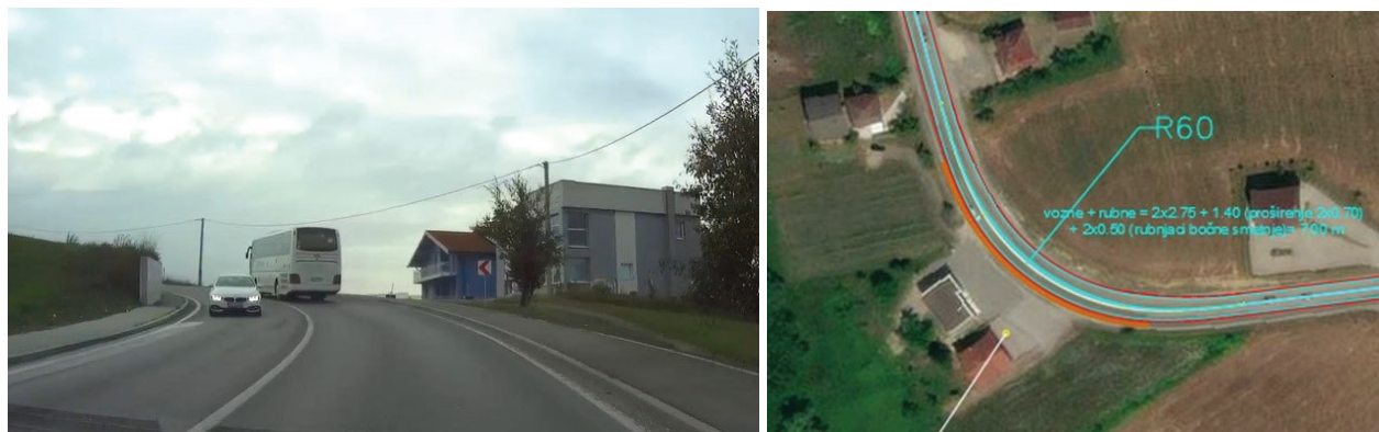
Slika 2: Kombinacija vertikalne i horizontalne krivine i predloženo rješenje
