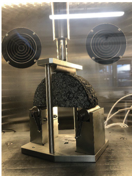
Slika 2. Ispitivanje polucilindričnog asfaltnog uzorka prema SCB testu (EN 12697 – 44)
