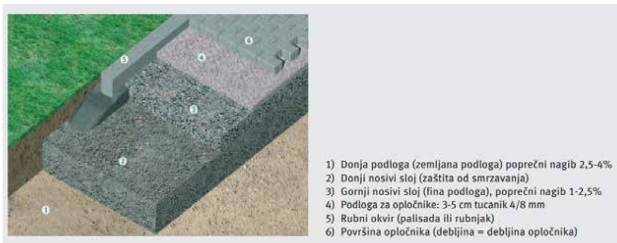
Slika 6. Uputstva za polaganje Semmelrock betonskih opločnika [4]
