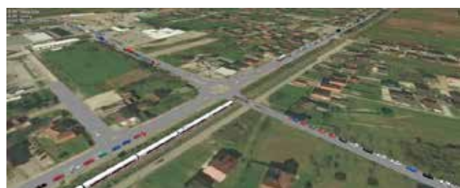
Slika 19. Mikrosimulacijski model jednotračnog kružnog toka sa pružnim prelazom
