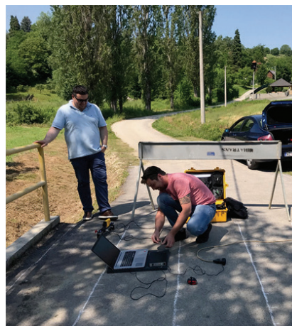
Slika 9. Priprema za ispitivanje metodom IMPACT-ECHA
