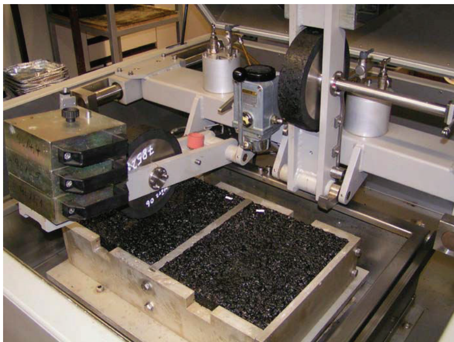
Slika 6. Odredjivanje otpornosti asfaltne mješavine na deformacije pomoću testa za simulaciju nastajanja kolotruga Izvor: [8] Tehnički Univerzitet TU Duisburg-Essen
