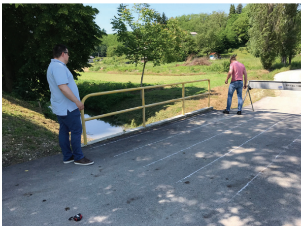
Slika 9. Priprema za ispitivanje metodom IMPACT-ECHA
